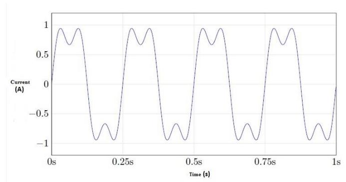
Figure 5 Non Linear Load Curve
