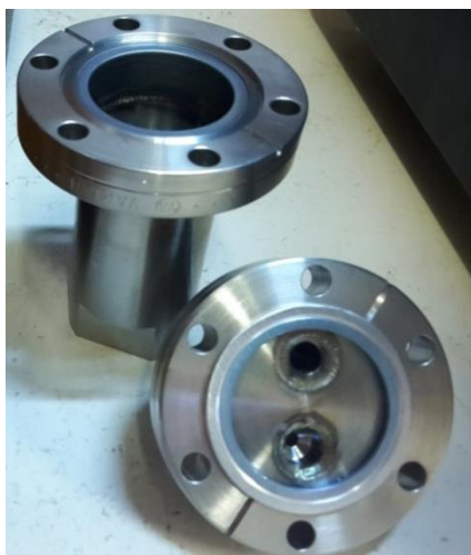
Figuur 3.8: Reaktore met aluminiumseël sigbaar
