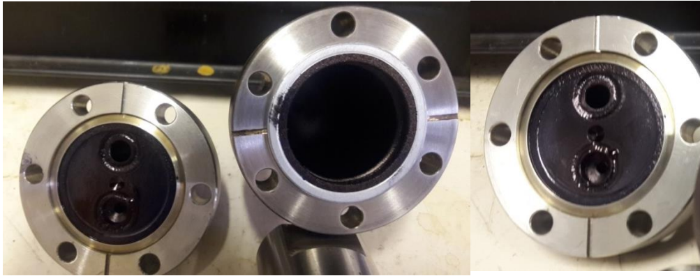
Figuur 4.43: Reaktore met oksifluoried neerslag
