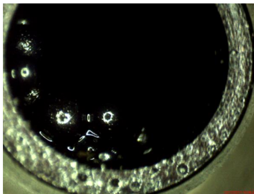
Figuur 4.44: Neerslag se tekstuur onder mikroskoop beskou
