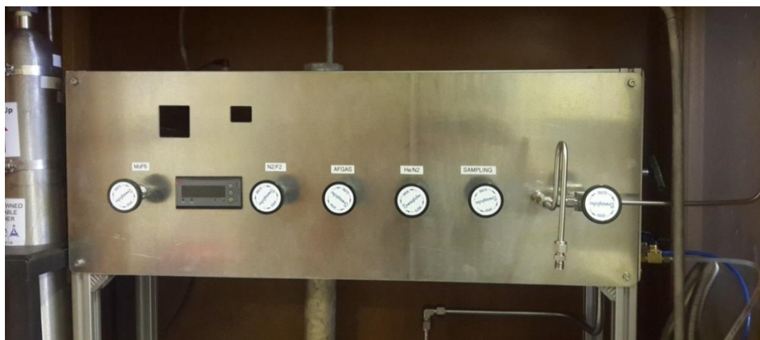
Figuur 3.3: Spruitstuk met kleppe om gastoevoer na reaktore in oond te voorsien
