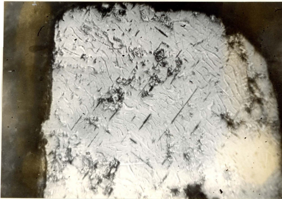
FOTO XII: wurmagtige vergroeiings (liggers) in magnetiet (grys). Steynsdrift 145 JS. Gekruiste nicols, olieimmersie, X 650.
