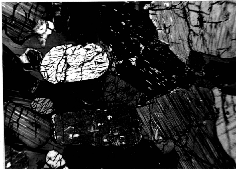
Foto 5: Veldspatiese pirokseniet: ortopirokseen vol insluitels van klinopirokseen. Groot ortopirokseen toon translasielamelle; klein pirokseenkristalle in tussenkorrelrige plagioklaas is vry daarvan.
