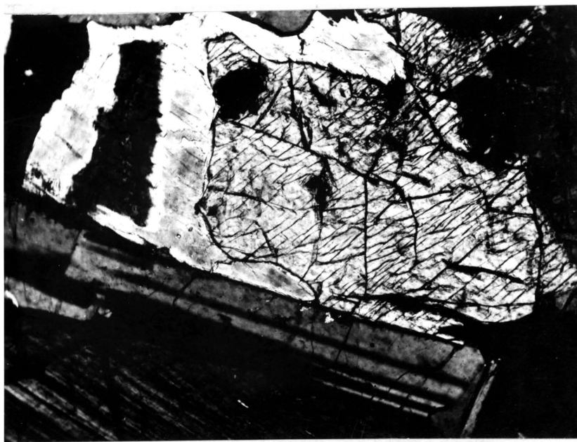
Foto 16: Klinopirokseen omsluit en vervang ortopirokseen. Uitloper behou skerp kontak met (010)-vlak van plagioklaas.
