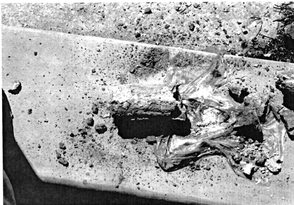
Foto 6.4 B2(7.7m) - Totaal verweerde Siëniet
