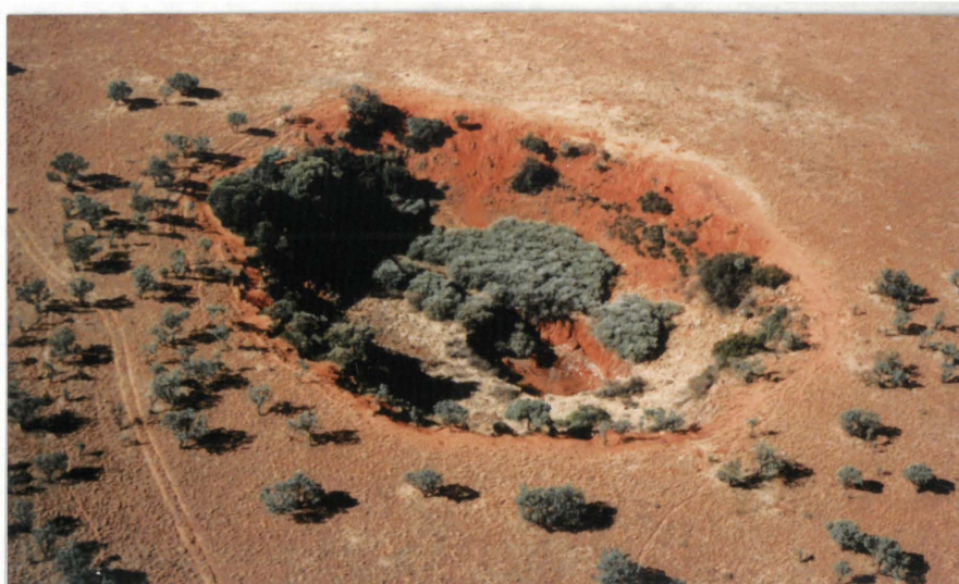
foto 13 HERHALENDE INSAKKING VAN DIE VULSEL VAN 'N OERSINKGAT IN DIE NIE-ONTWATERDE TURFFO TEINKOMPARTEMENT.
