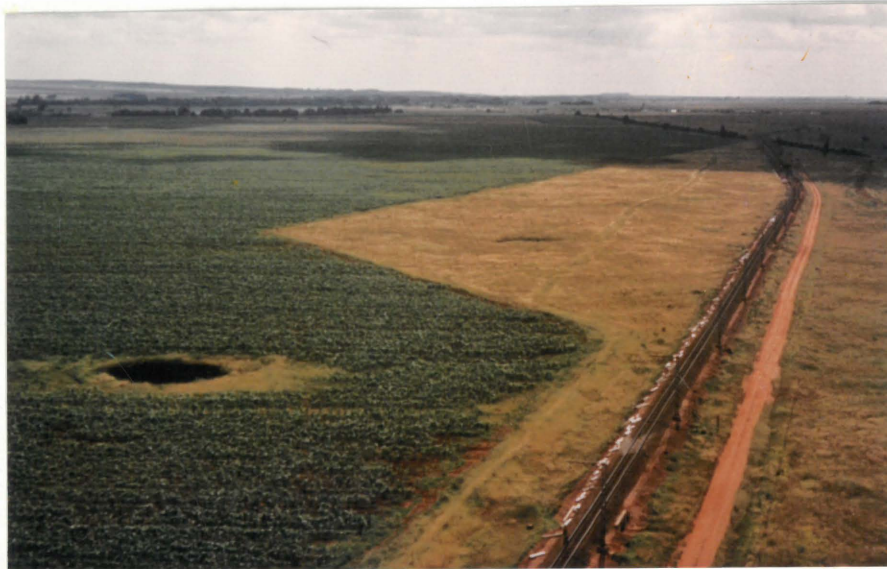
foto 37 EEN VAN DIE VIER SINKGATE WAT SEDERT 1963 LANGS DIE VERLEGGINGSPOOR GEVAL HET.
