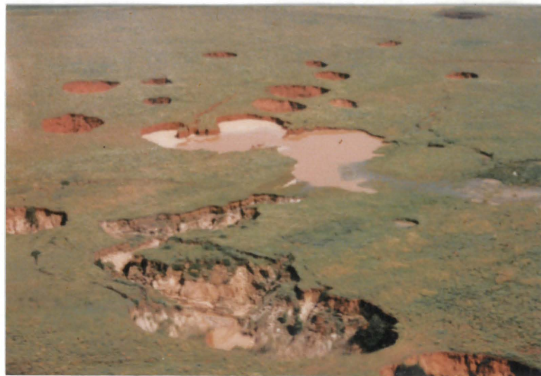
foto 21 SAAMTROSSING VAN SINKGATE NA OORSTROMING VAN DIE WONDERFONTEINSPRUIT IN JANUARIE 1978.
