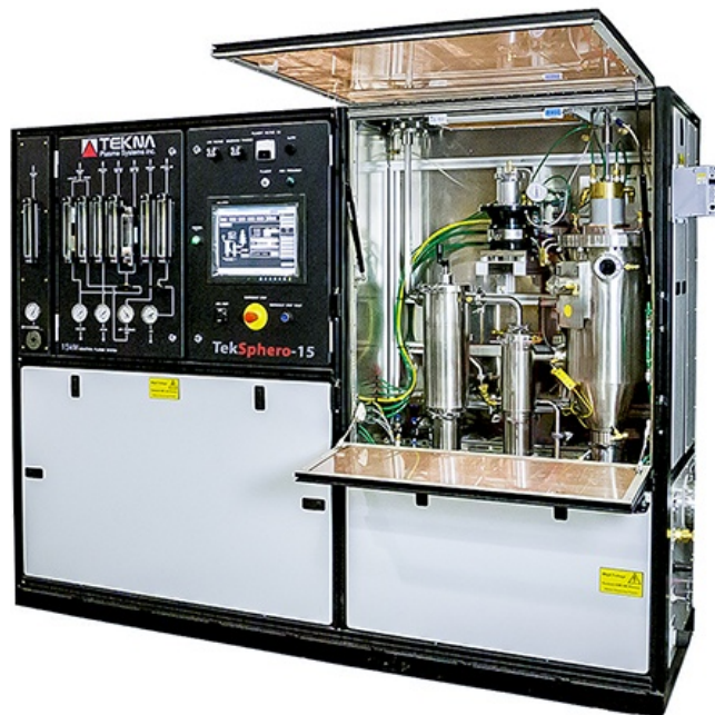
Figuur 16: Die Tekna TekSphero-15 IGP-sferoïediseringstelsel.
