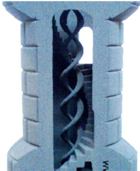
Figuur 1: Detail van 'n 3D gedrukte kasteel met 'n dubbele helix aan die binnekant, voorbeeld van 'n komplekse geometrie wat maklik vervaardig word op 'n 3D drukker (Gebhardt & Hötter, 2016: 6).
