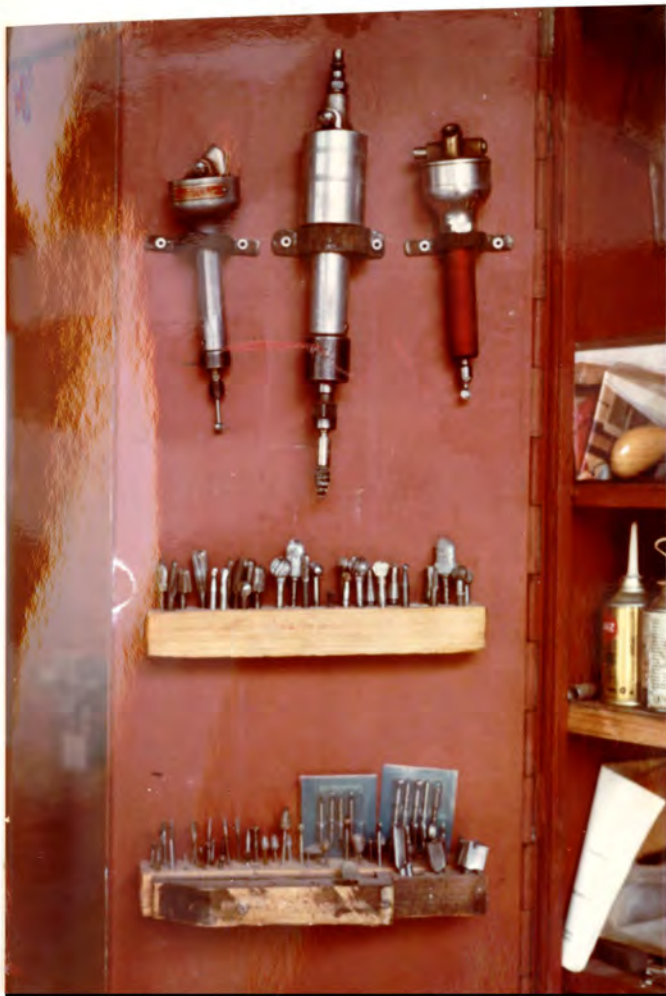
Afbeelding 21: Hennie se gereedschap: Bo: Lugdraaiapparaat. Onder: Draaivyltjies.
