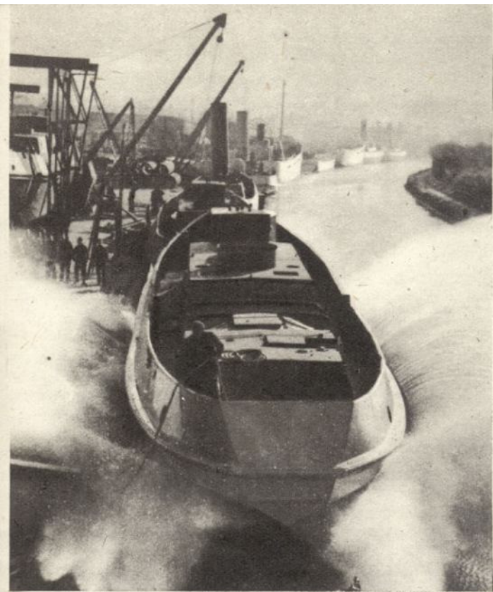
Na vier dagen is de sleepboot in elkaar gezet en kan zij te water worden gelaten.
