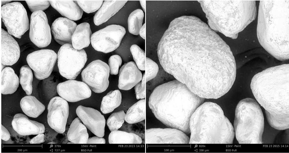
Figure 3-4: SEM images of ilmenite
