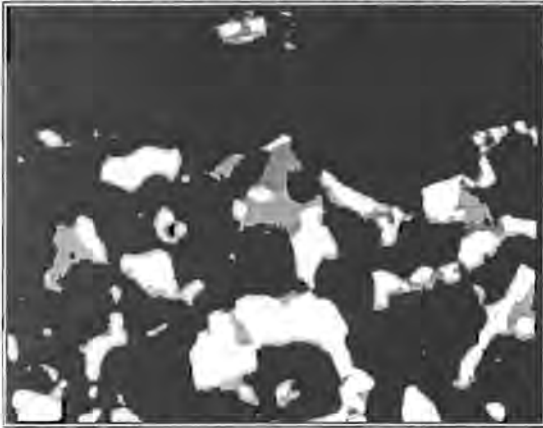
Figuur 3-8 Mikroskopiese beeld van korrel met 90% metallisasie by ongeveer 100x vergroting
