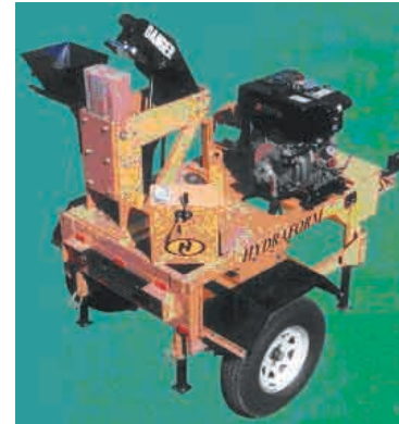
Fig. 5.33 'n Hydraform blokmakmasjien met dieselmotor
