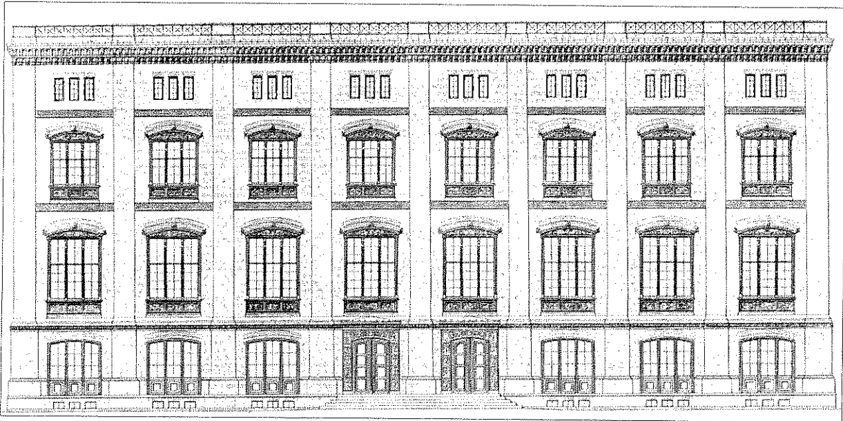
Fig. 3.46: Allgemeine Bauschule: Schinkel. (Hazlett 1989:117). Die natuurlike strewe na 'n sentrale ingang word hier opgeoffer aan strukturele konsekwentheid: die pilasters tussen die hoofdeure is deurlopend. Selfs die hoekpilasters wat gewoonlik beklemtoon word, verbreek nie die reëlmatigheid nie. Duitse argitekte onder wie Gilly en Schinkel, volg hierin die Franse revolusionêre argitekte na (Kaufmann 1966:117). Die rasonele speel hier 'n groot rol. Wierda verkies egter die Baroksisteem van aaneenskakeling, integrasie en skakering.
