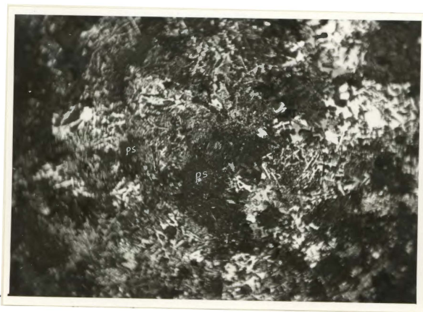
Foto 2B. Pseudosferuliete (ps) wat omsluit word deur 'n grafiese vergroeiing van kwarts (wit) en veldspaat (grys) in 'n pseudosferulitiese, granofiriese felsiet (G20:13), afkomstig van Kromdraai 58. (Dieselfde as Foto 2 A ).
