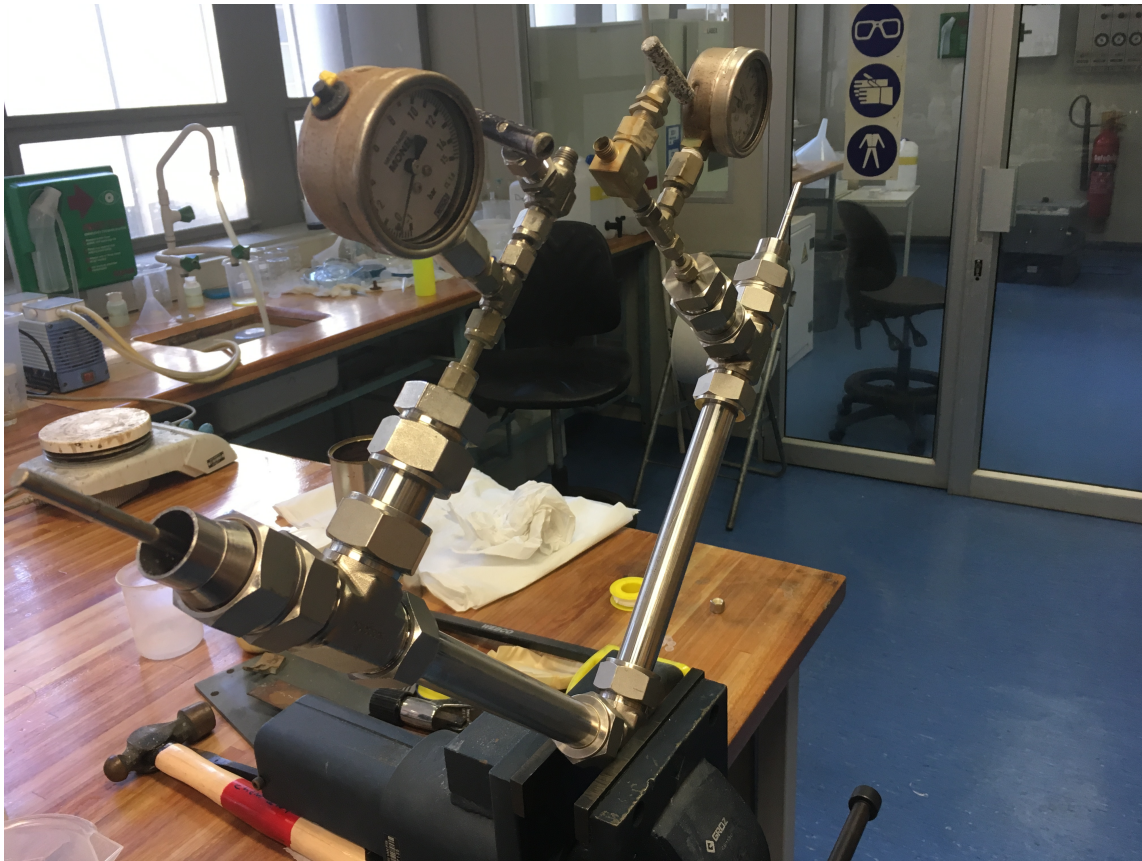
Figuur 2.29: Laai van die KF · HF-sout tot die fluoorsel met gebruik van 'n bankskroef.
