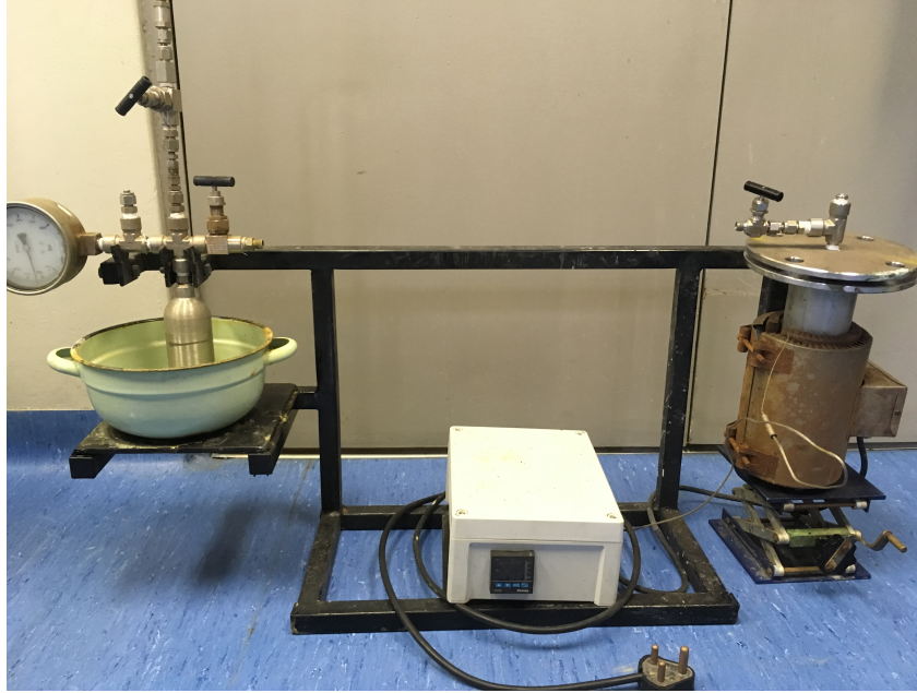
Figuur 2.19: Foto van die HF-lotreaktor se opstelling buite 'n dampkas vir beter sigbaarheid. Let daarop dat die vakuumpomp en kouval nie hier sigbaar is nie. Die HF-lotreaktor is aan die regterkant in die verhittingsklos gemonteer. Die temperatuurbeheerder is in die middel van die staander en die HF-oordragsvat aan die linkerkant gemonteer. Die liggroen vloeibarestikstofhouer staan onder die HF-oordragsvat.
