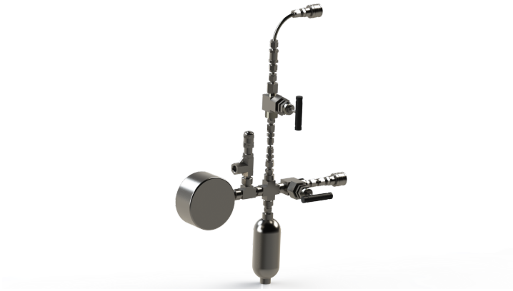
Figuur 2.15: 3D-ontwerp van die HF-oordragsvat.
