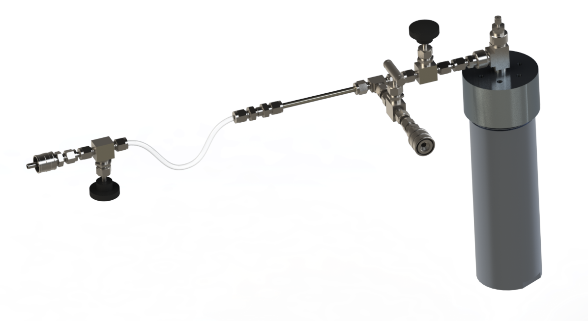
Figuur 2.12: 3D-skets van die tweede weergawe van die HF-lotreaktor.
