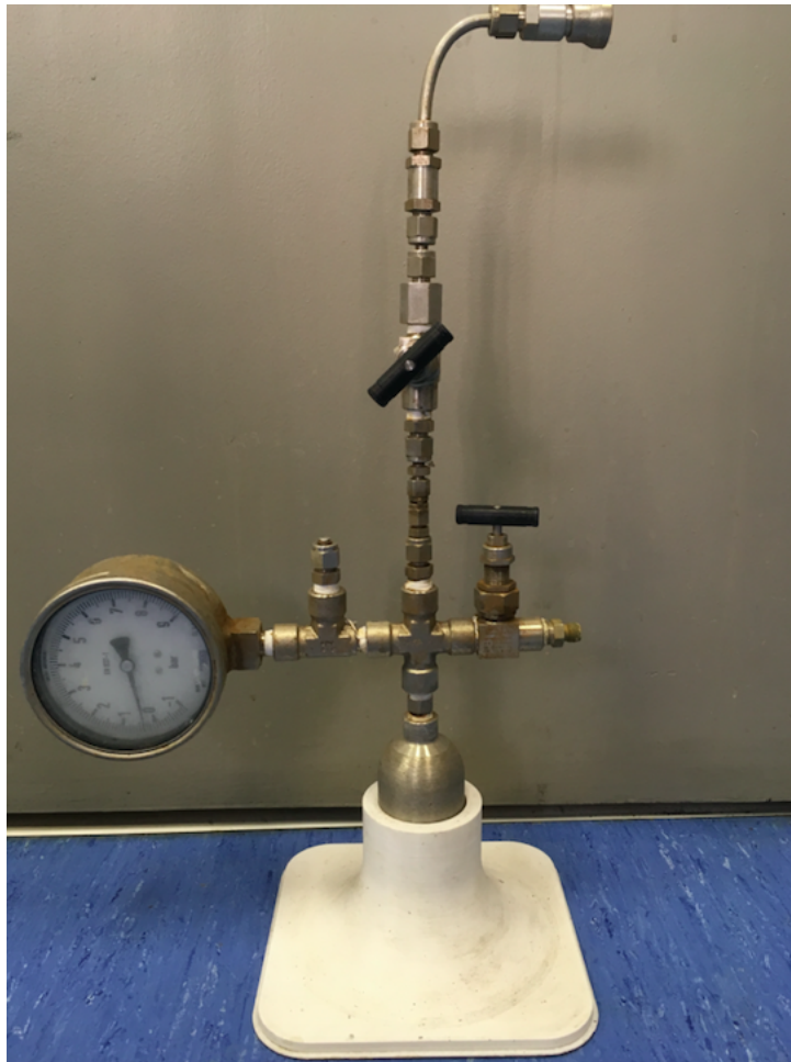
Figuur 2.16: Foto van die HF-oordragsvat in sy gepaardgaande staander. Die staander is as 'n 3D drukstuk vervaardig.
