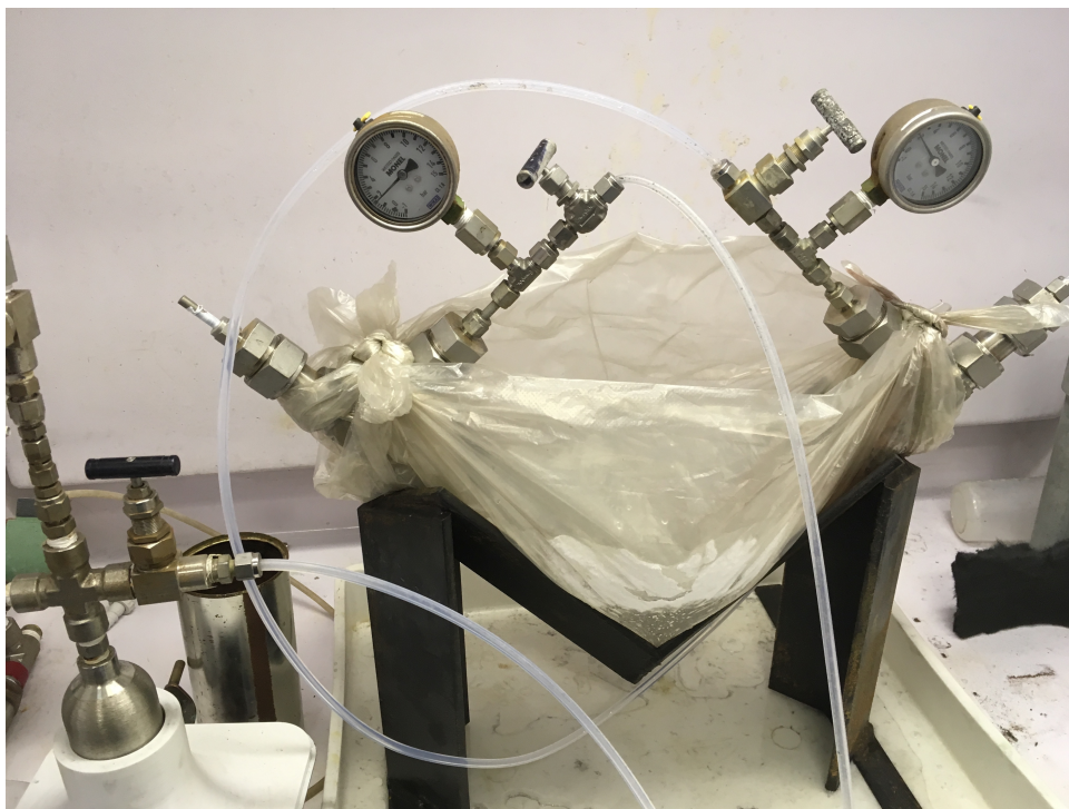
Figuur 2.28: Foto van 'n plastieksak wat aangewend word om 'n metanolysbad om die reaksiebuis te onderhou. Let daarop dat alle elektriese toerusting en verbindinge ontkoppel is.
