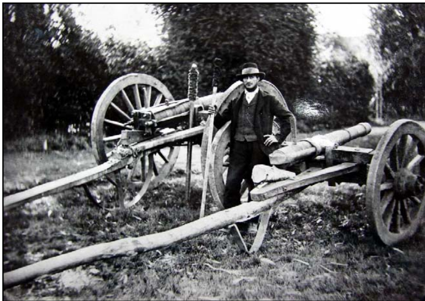
Die heer Marthinus J. Ras staat hier tussen die twee kanonne, wat hij eigenhandig v'r die republiek gemaak 't, hoofdsakelik uit wa-bande. Die stelle bestaan uit gewone wa-stelle. Die stukke werd in 1880-81 gemaak en gebruik te Potchefstroom. Een van die ou stukke is in die museum te Pretoria, die ander was naar die Parijse tentoonstelling van 1900, en is nou te Dortrecht Holland. Ras word deur Linchwe s'n kaffers vermoor in 1900 nabij Derdepoort. [Bra-50 p8]
