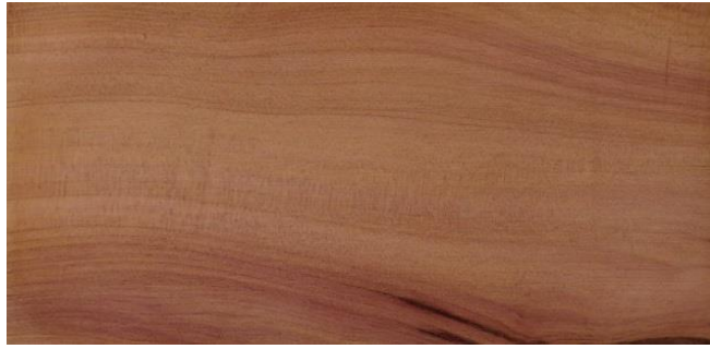
Figuur IV-11: Die aromatiëse, rooierige hout van die Bermuda seder ( Juniperus bermudiana ). Uit: Hobbit House Wood ID Site, Juniper, http://hobbithouseinc.com/personal/woodpics/juniper.htm , 8 August 2018.
