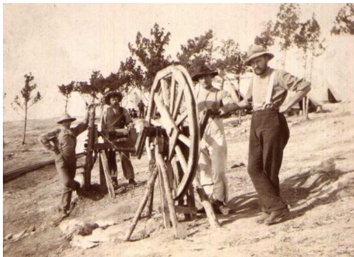
Figuur IV-8: Krygsgevangenes op Bermuda by die rudimentêre, handgedrewe draaibank wat hulle self geprakseer het.
