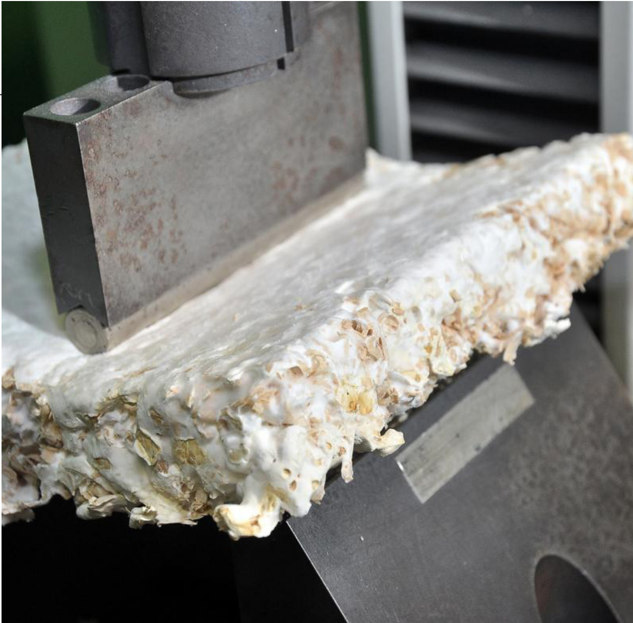
Fig. 3.14: Mycelium strength test (Bizjournals: 2013)
