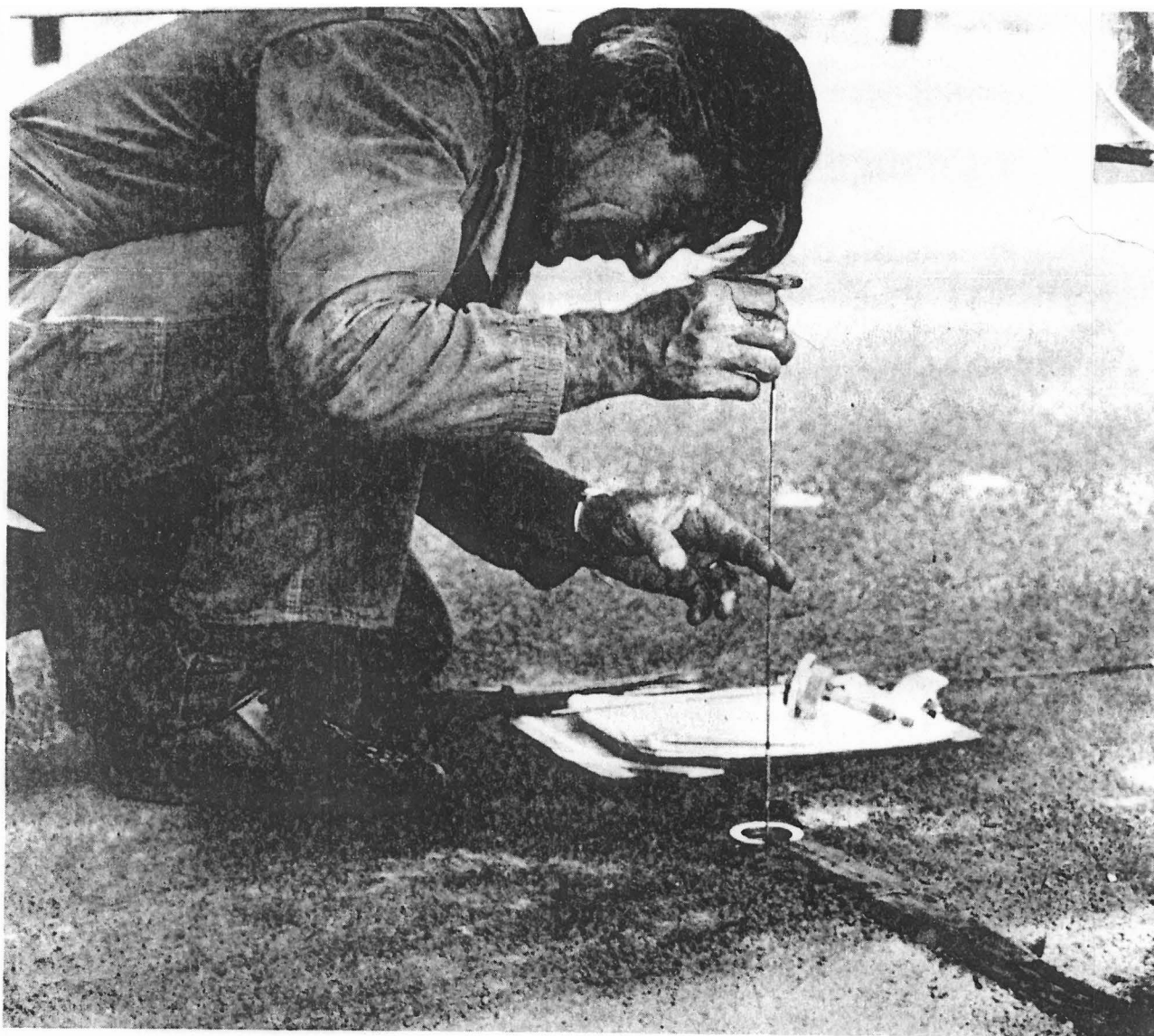
'n Meerdieptedieksiemeter word in 'n padplaveisel aangebring
