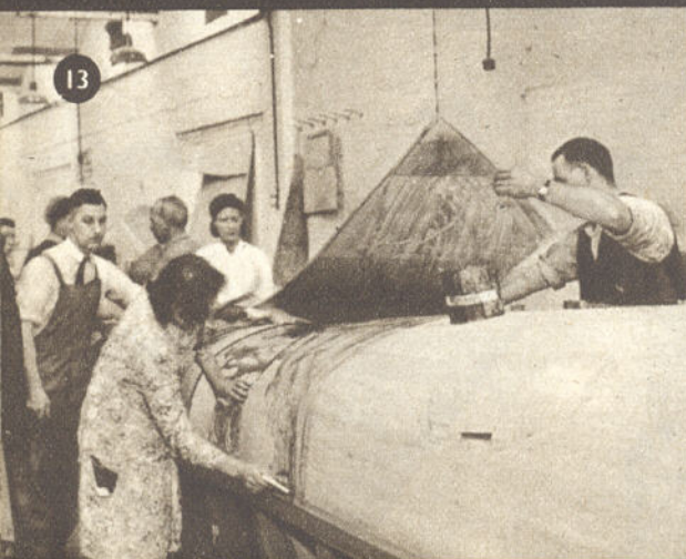
13 De rompvorm wordt in twee delen gebouwd.
