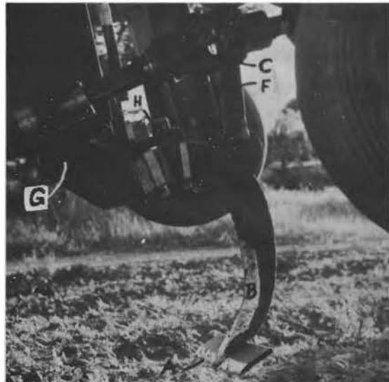
Plaat 2. Enkellem vibrasieploeg, skuins van die kant gesien.
