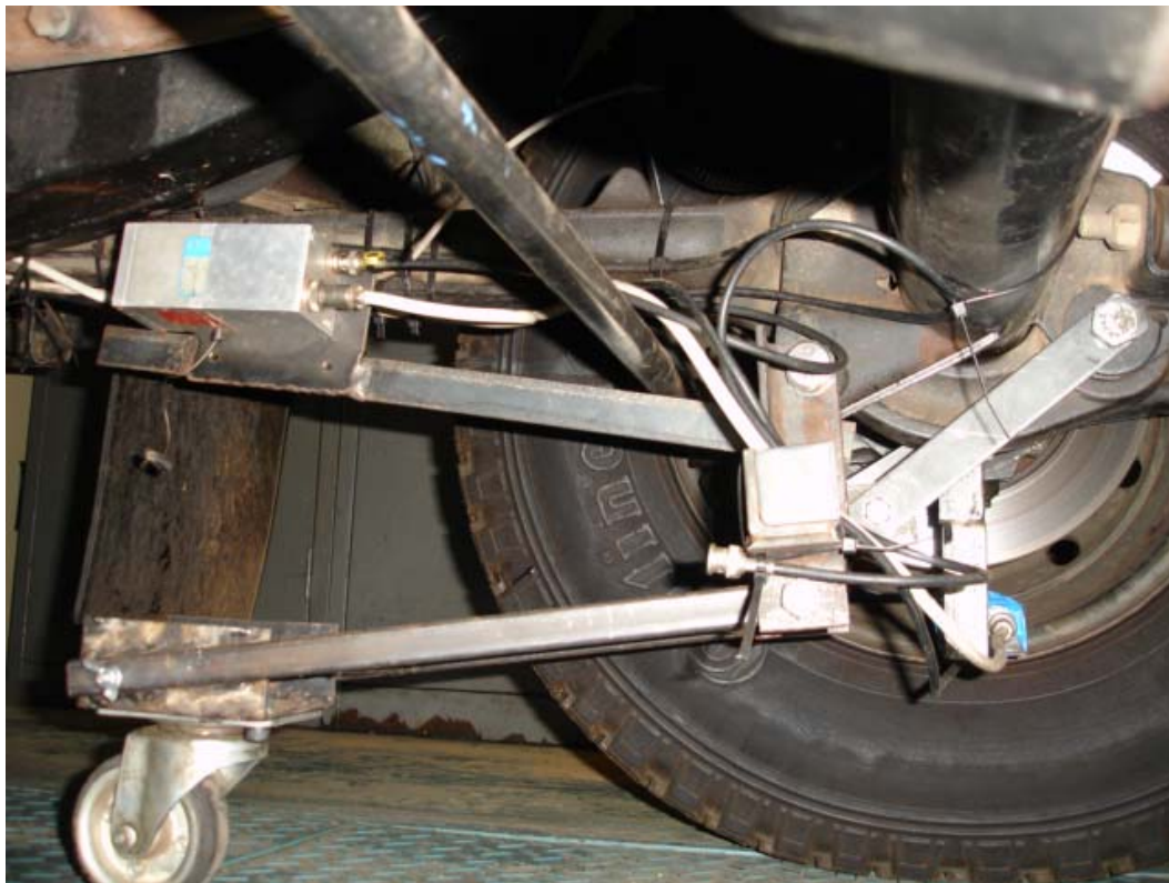
Figuur 3.6 – Die meganisme wat gebruik is om die hoeveelheid wat die wiel links voor op lig, te meet.
