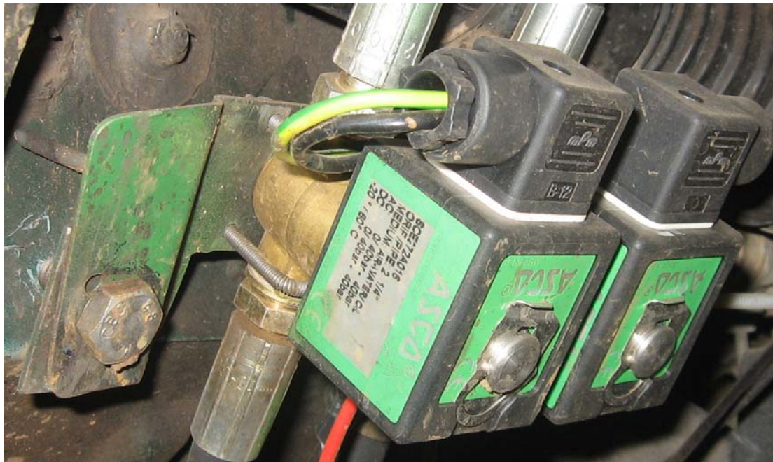
Figuur 3.8 – Om die gaslaaiproses makliker en meer akkuraat te maak, is solenoïed-kleppe geïnstalleer.
