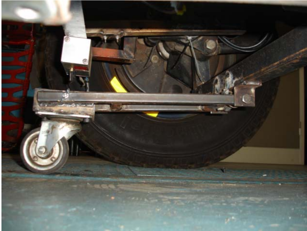
Figuur 3.5 – Die meganisme wat gebruik is om die hoeveelheid wat die wiel links agter op lig, te meet.
