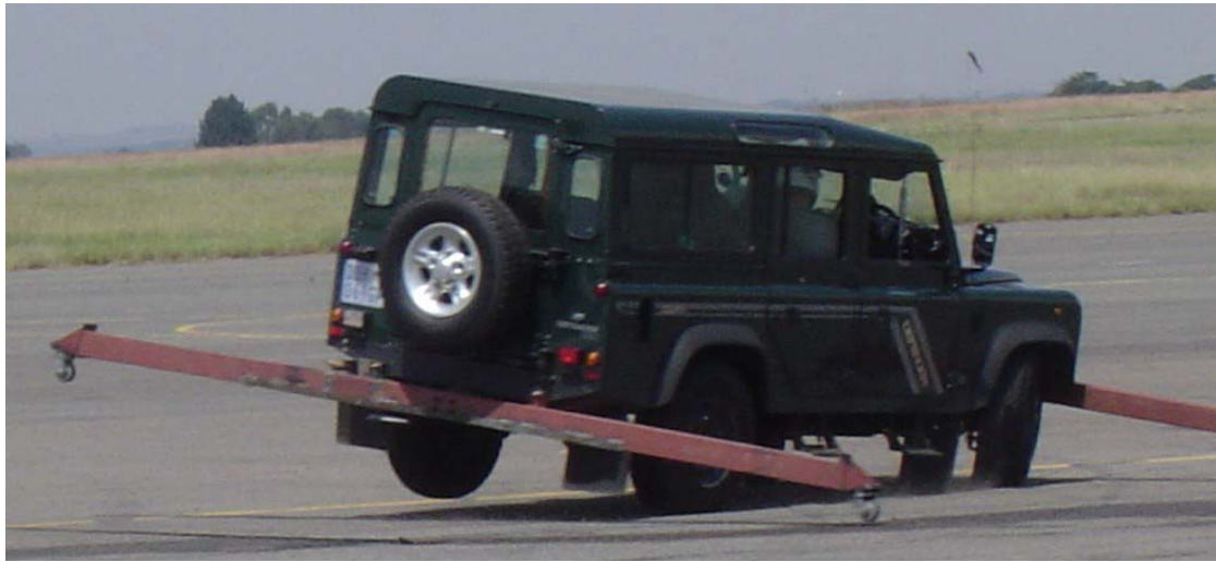
Figuur 3.10 – Die agterwiel aan die linkerkant van die voertuig lig op tydens 'n toetslopie.
