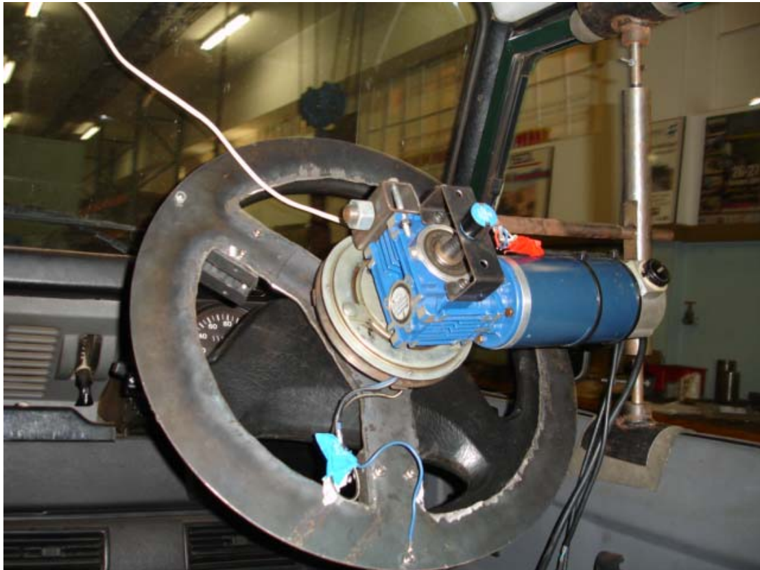
Figuur 3.3 – Die stuurrobot wat gebruik is om redelike herhaalbaarheid te verseker, gemonteer op die stuurwiel.
