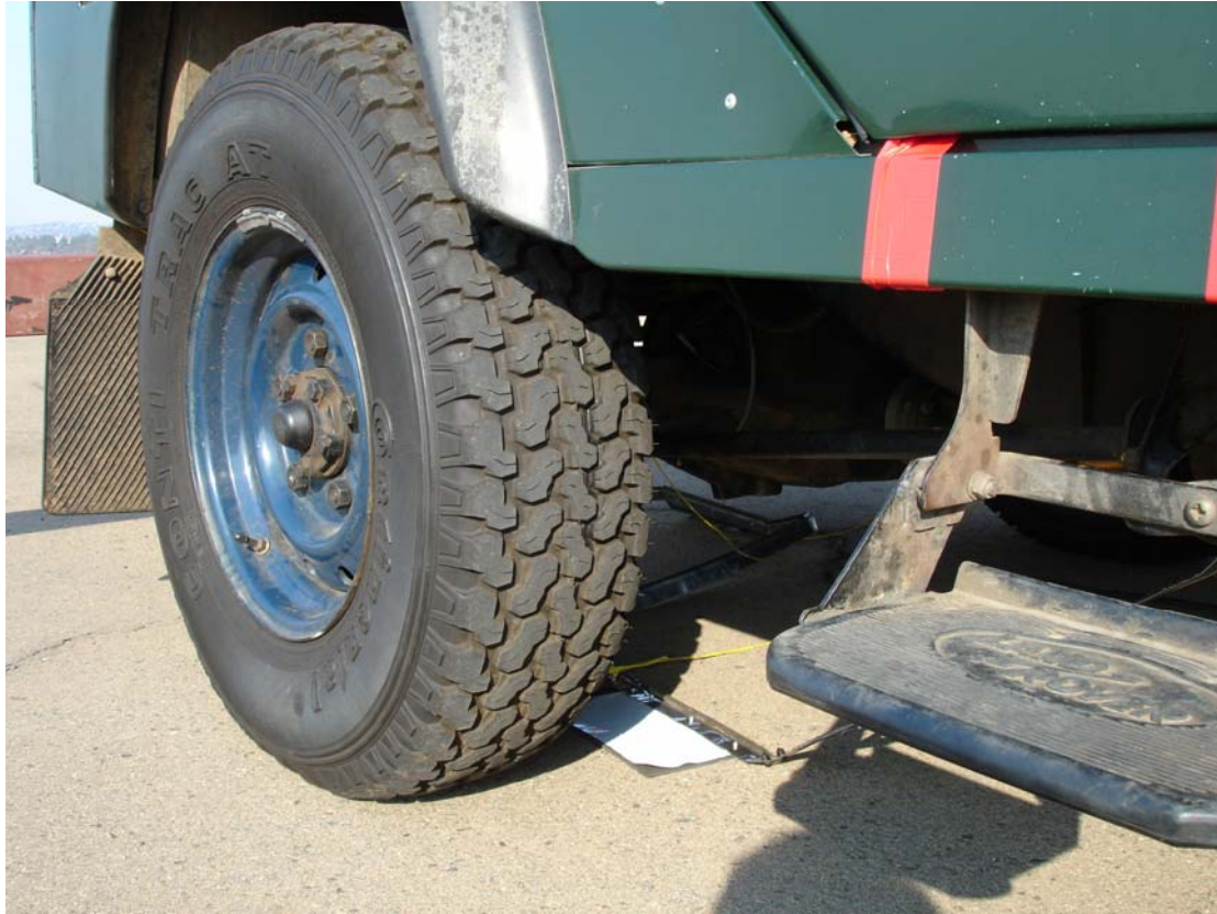
Figuur 3.4 – Die slee onder die voertuig vir gebruik saam met die laserverplasingmeters.
