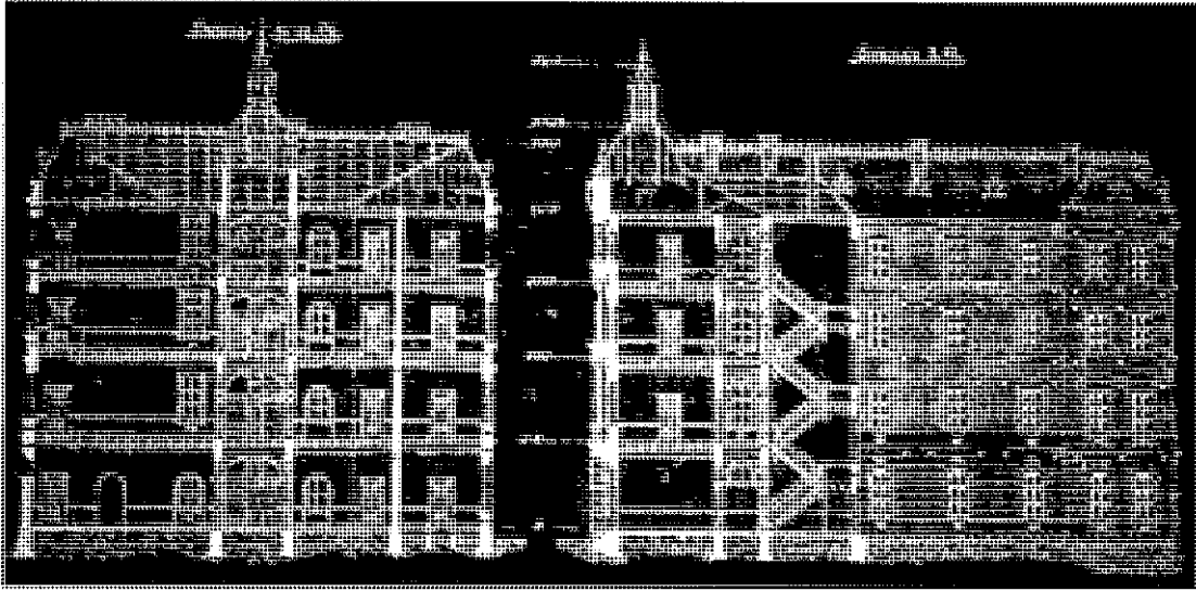
Fig. 3.19: 'Nieuwe Kantoorgebou', Pretoria: Doorsnede. 1897, voor wysigingsopdragte. (TABA 8073) Skaal aangedui op alle tekeninge.
