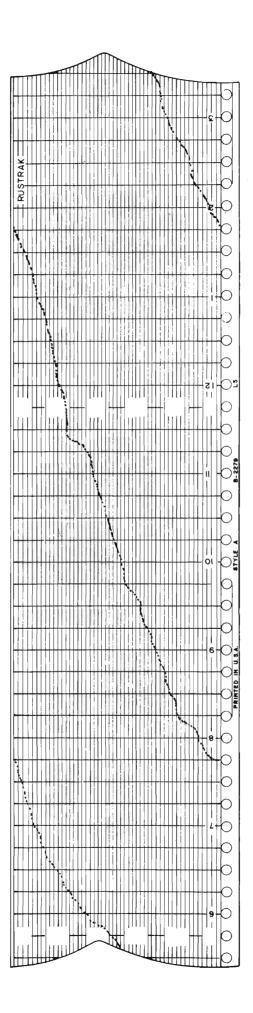
FIGURE 11.3 - RAIN GAUGE OUTPUT
