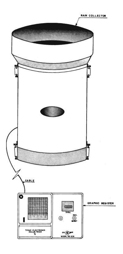
FIGURE 11.2 - AUTOMATIC ELECTRONIC RAIN GAUGE
