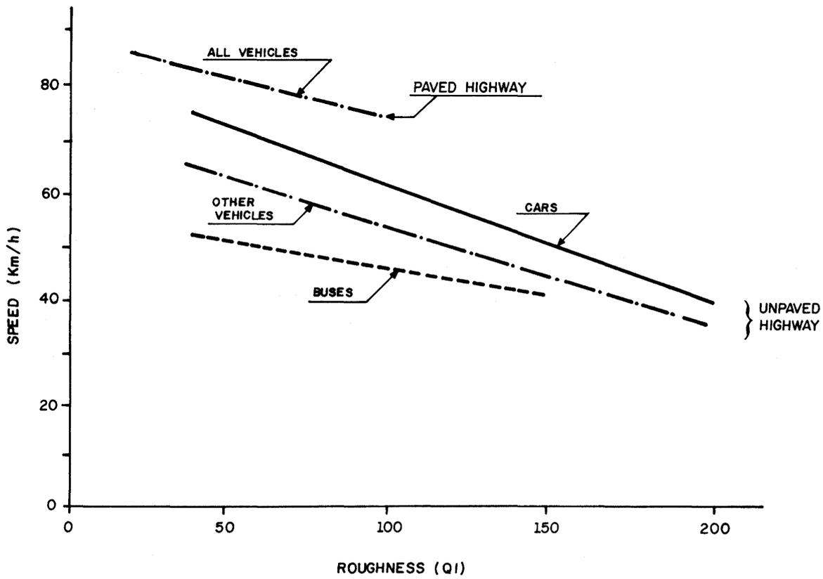
FIGURE 3.1- INFLUENCE OF ROUGHNESS ON FREE - FLOW SPEED ( GRADE = 0,2%)
