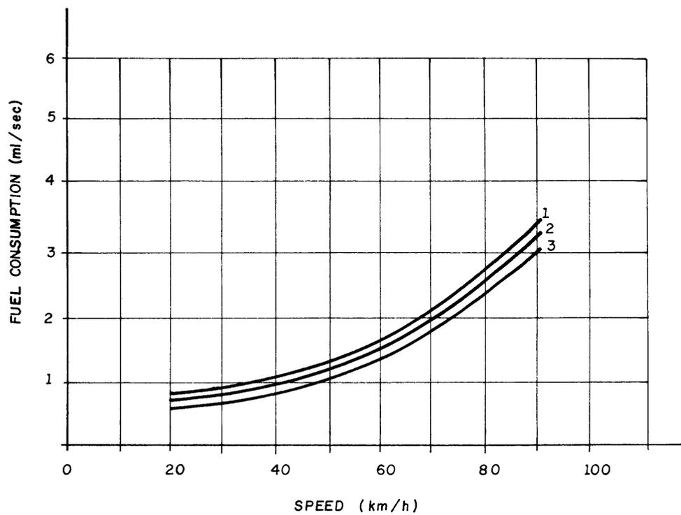
FIGURE 3.2- EFFECT OF ROUGHNESS ON FUEL CONSUMPTION.
