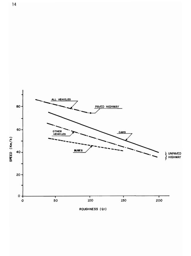
FIGURE 3.1- INFLUENCE OF ROUGHNESS ON FREE - FLOW SPEED ( GRADE = 0,2%)
