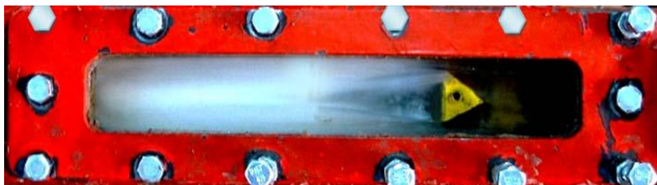
(d) Breakdown cavitation ( Q = 4.86 lit/sec )
