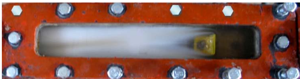
(d) Breakdown cavitation ( V= 8.75 m/sec Q = 4.7 lit/sec )
