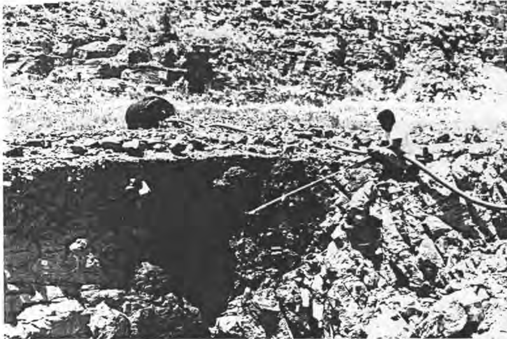
FOTO 3 : Opgaartenk en templaat wat vir die waterspuittoetse gebruik is.
