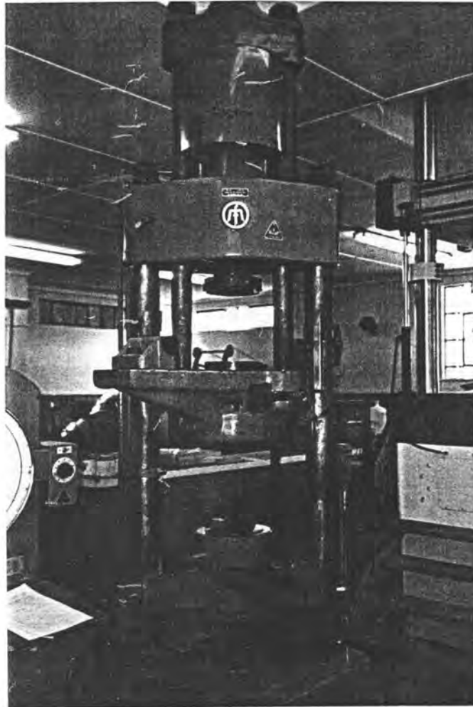
FOTO 11 : Pers wat gebruik is vir verdigting van materiaal.
