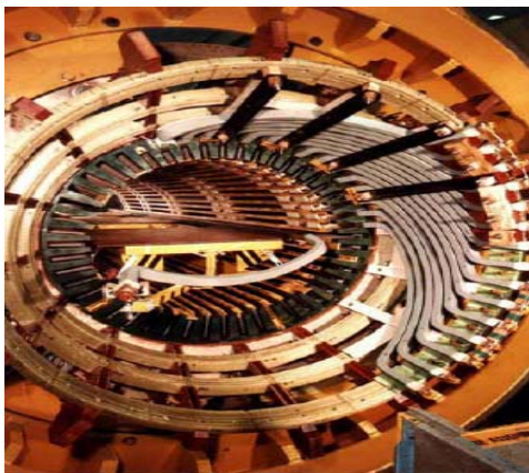
a. Generator stator
